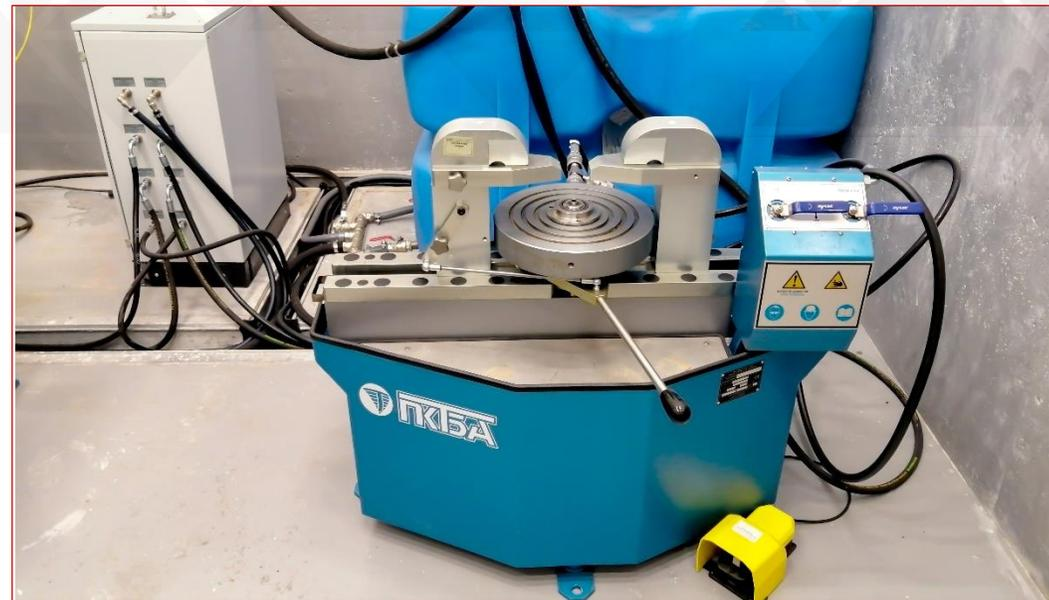
Стенд для испытаний и настройки предохранительных клапанов.
