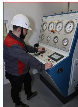
Пневмогидростанция для гидравлических и пневматических испытаний.
