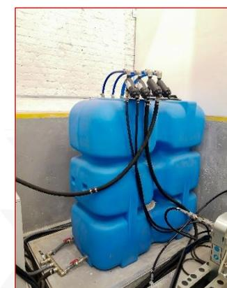
Станция оборотного водоснабжения  $V_{бака}=1,5м3$ .
