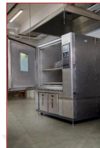
**Климатическая камера Terchy MNU-800 CNSA.** Испытания на воздействие температуры и влажности.
