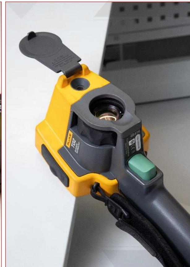
**Тепловизор Fluke Ti32.** Визуализация бесконтактного измерения и регистрации радиационной температуры объектов.
