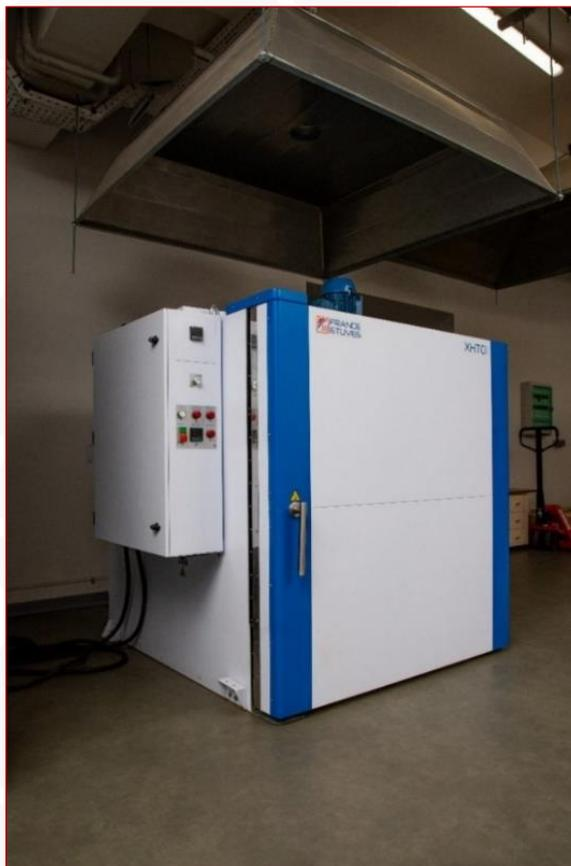
**Сушильный шкаф ХНТ01.** Испытания на воздействие температуры в диапазоне от 20° до 500°.
