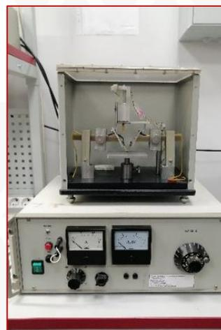
**Установка УПС.** Проверка стойкости к образованию токопроводящих мостиков.
