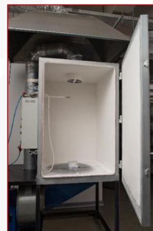
**Камера пыли KTP-800.** Проверка степени защиты оболочек на воздействие ПЫЛИ.
