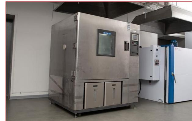
**Камера климатическая Terchy MHU-800 CNSA.** Испытания на воздействие температуры в диапазоне от минус 70° до 150° и относительной влажности от 20% до 98%.
