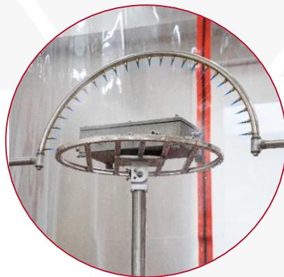
Испытания на степень защиты IP
