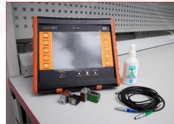
Дефектоскоп ультразвуковой УСД-50 IPS. Проведение неразрушающего контроля материалов и сварных соединений, координат залегания дефектов и оценке их параметров.
