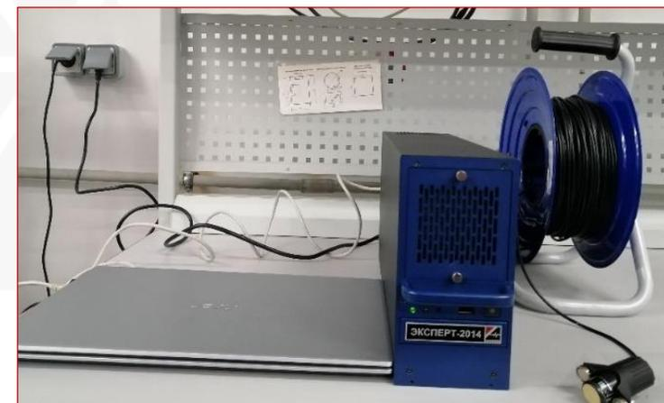
Акустико-эмиссионный комплекс «Эксперт – 2014». Предназначен для обнаружения локализации и определений степени опасности развивающихся дефектов.
