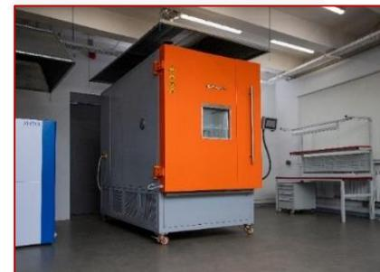
**Испытательная камера KTXB-2000.** Испытания на воздействие температуры в диапазоне от минус 70° до 150° и относительной влажности от 20% до 98%.
