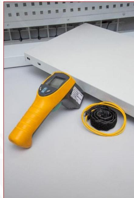
Пирометр инфракрасный Fluke 561. Бесконтактное измерение температуры поверхности.
