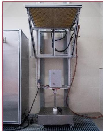
**Испытательный стенд степени защиты от проникновения воды IP X1-X2.** Проверка степени защиты IP оболочек от проникновения воды в соответствии с ГОСТ 14254
