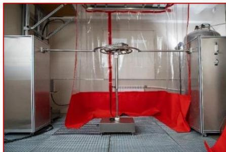
**Испытательный стенд степени защиты от проникновения воды IP X1-X8.** Проверка степени защиты IP оболочек от проникновения воды в соответствии с ГОСТ 14254.
