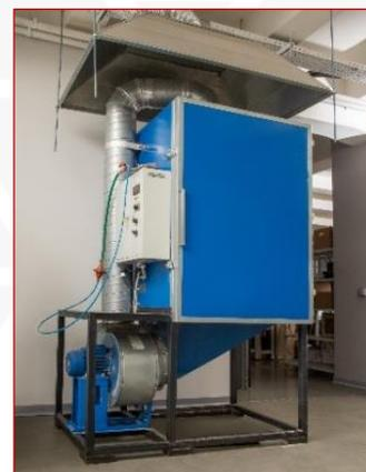
**Камера пыли КТП-800.** Проверка степени защиты IP5X-IP6X оболочек на воздействие пыли в соответствии с ГОСТ 14254.
