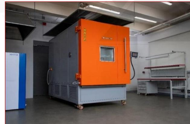
**Испытательная камера КТХВ-2000.** Испытания на воздействие температуры в диапазоне от минус 70° до 150° и относительной влажности от 20% до 98%.
