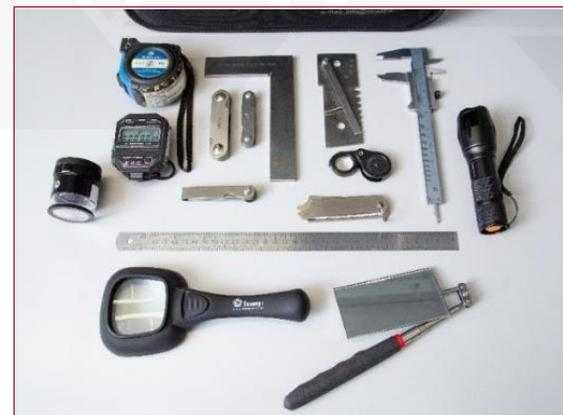
Комплект для визуального и измерительного контроля ВИК. Измерение размеров и выявления поверхностных дефектов.
