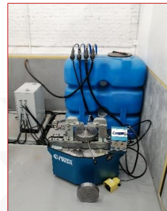
Станция обратного водоснабжения V_{бака}=1,5\text{м}^3 .
