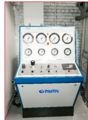
Пневмогидростанция для гидравлических и пневматических испытаний.
