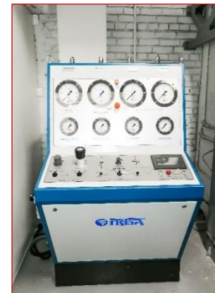
Пневмогидростанция для гидравлических и пневматических испытаний.
